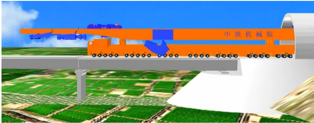
Figur 35 : Maskinen är demonterad och kör igenom en tunnel.
