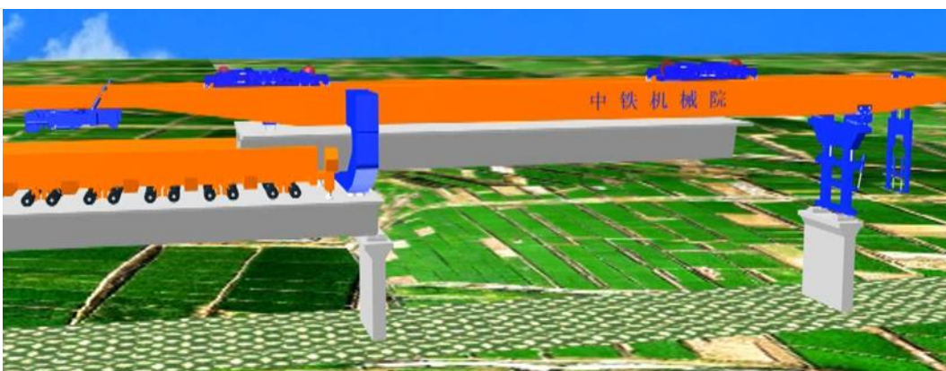
Figur 33 : Nytt brobane element monteras.
